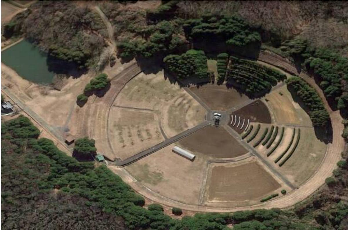
„Gamma-Garten“: Wichtigster Bestandteil war eine Röhre mit radioaktivem Material in der Mitte, üblicherweise das radioaktive Isotop Cobalt-60. Um diesen herum wurden in konzentrischen Kreisen verschiedene Pflanzen angebaut. Diese wurden so angeordnet, dass Pflanzen in verschiedenen Teilen des Gartens unterschiedlichen Mengen an Strahlung ausgesetzt wurden.
